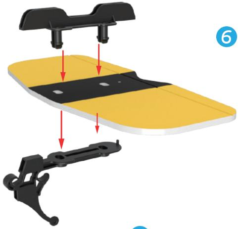
6 用尾翼翼台和尾翼座固定水平尾翼。
