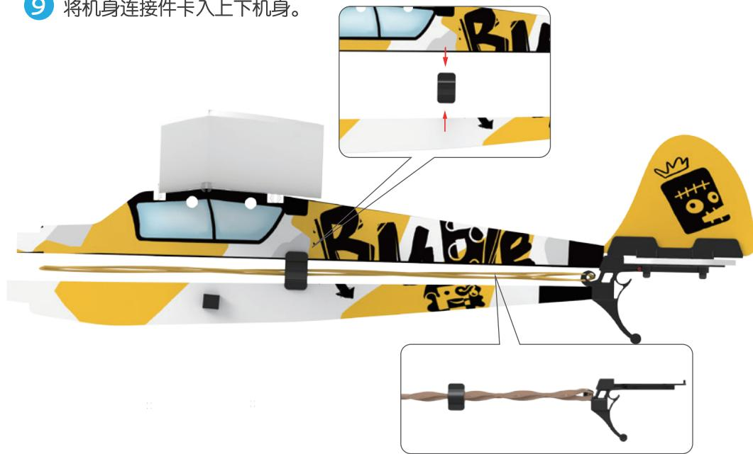
10 橡筋绕2圈打结，并将橡筋结置于尾翼座的尾钩处，再将橡筋穿过机身连接件。
