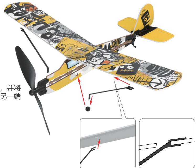
机翼支撑架安装细节图
