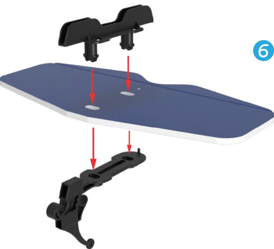
6 用尾翼翼台和尾翼座固定水平尾翼。
