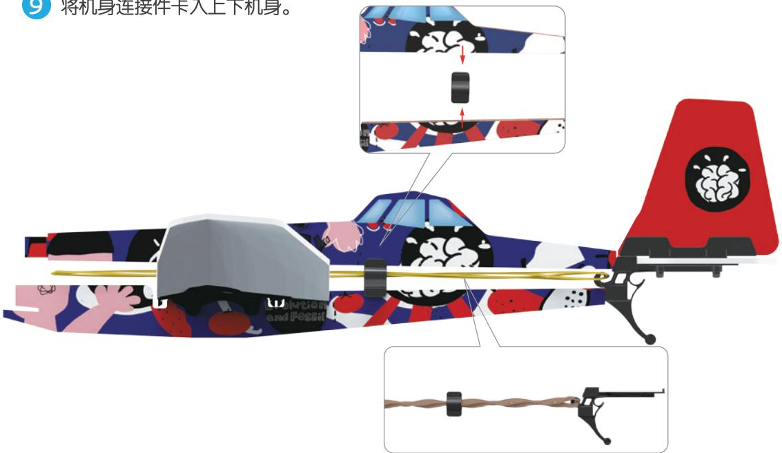
10 橡筋绕2圈打结，并将橡筋结置于尾翼座的尾钩处，再将橡筋穿过机身连接件。
