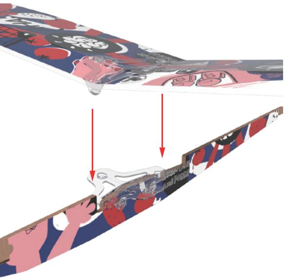
7 将垂直尾翼插入尾翼翼台。
