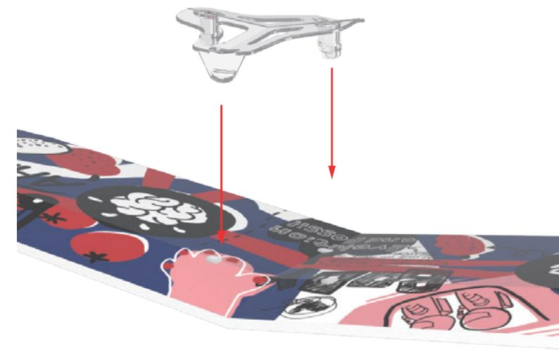
5 将机翼对准翼台中心装入，并盖上翼台压片。
