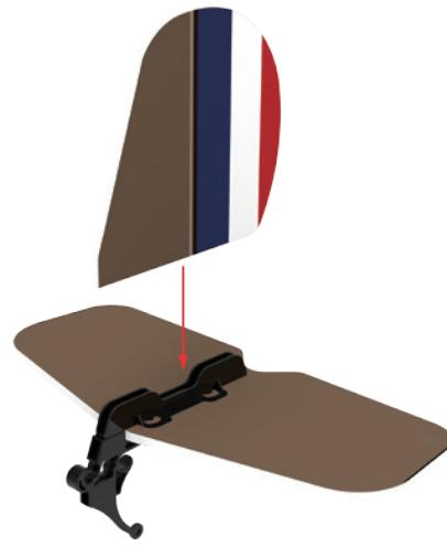
9 将垂直尾翼插入尾翼翼台。
