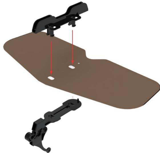
7 将两副机翼分别对准翼台中心装入，并盖上翼台压片。
