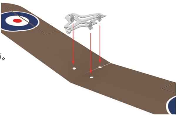
8 用尾翼翼台和尾翼座固定水平尾翼。
