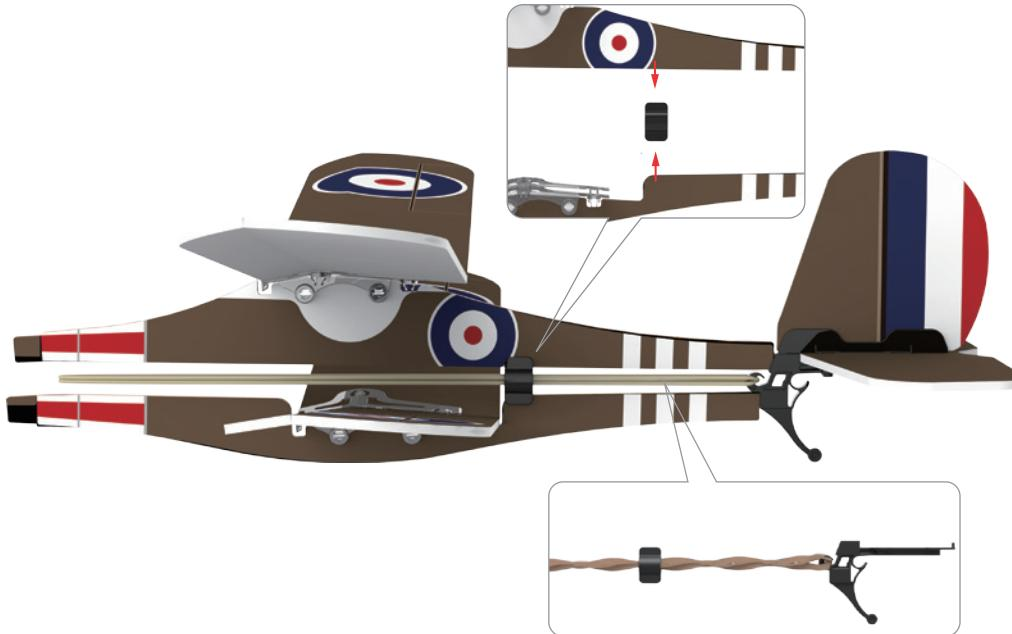
12 橡筋绕2圈打结，并将橡筋结置于尾翼座的尾钩处，再将橡筋穿过机身连接件。
