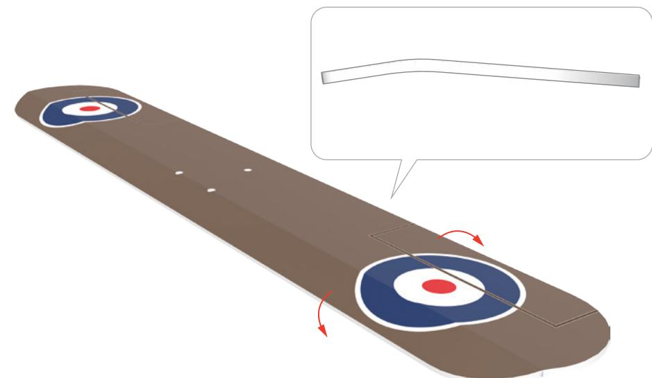
6 将翼台压片分别安装到两幅机翼上方。
